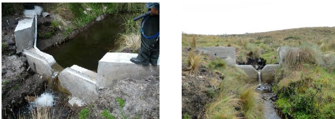
Figura 1: Ejemplos de vertederos de sección triangular y rectangular combinadas. Izq: vertedero en el páramo del volcán Pichincha, Lloa (CONDESAN). Der: vertedero en la cuenca del río Zhurucay, Paute (Grupo de Ciencias de la Tierra y del Ambiente de la Universidad de Cuenca).
