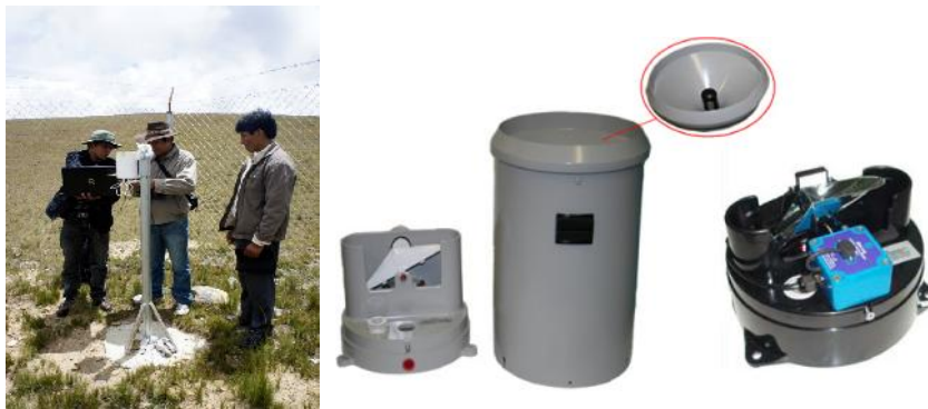
Figura 10 Muestra un pluviómetro instalado en campo y generando datos y en la derecha los detalles del pluviógrafo de balancines.
