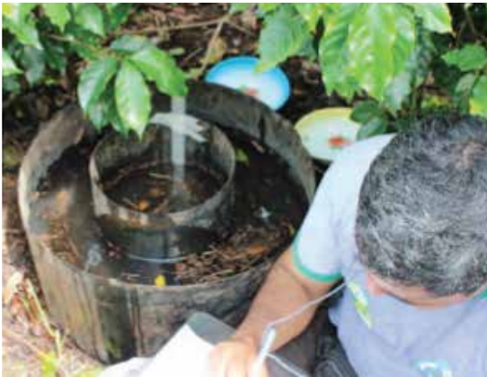
Figura 14. Medición de la infiltración del agua en una finca SAF de café bajo sombra.
