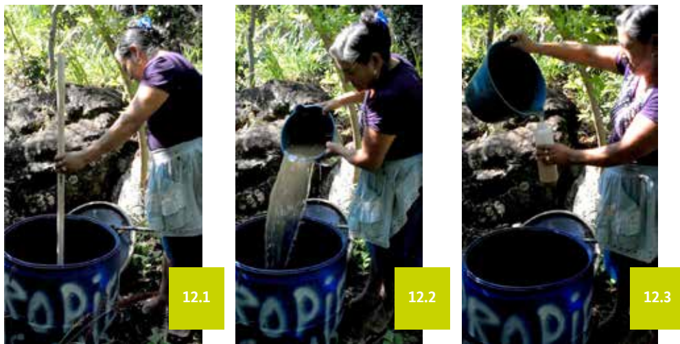
Figura 12. Proceso de recolección de muestra para la medición de pérdida de suelo. Implementado por la Sra. Rosalba Martínez en una parcela con un SAF de café especial bajo sombra. Microcuenca Mezcal, comunidad El Quebracho, municipio de Santa Catarina Mita. Guatemala.
