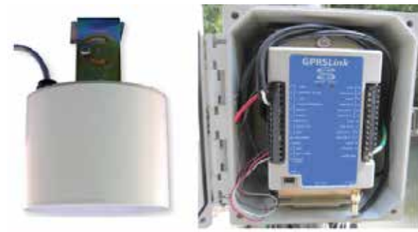
Figura 18. Radar de nivel marca Sutron modelo RLR-0003-1 y Datalogger con modem GPRS para enviar aforos en tiempo real a un celular.
