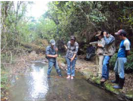
Figura 16. Aforo de la quebrada Marroquín en la microcuenca Marroquín con un molinete tipo pigmeo.
