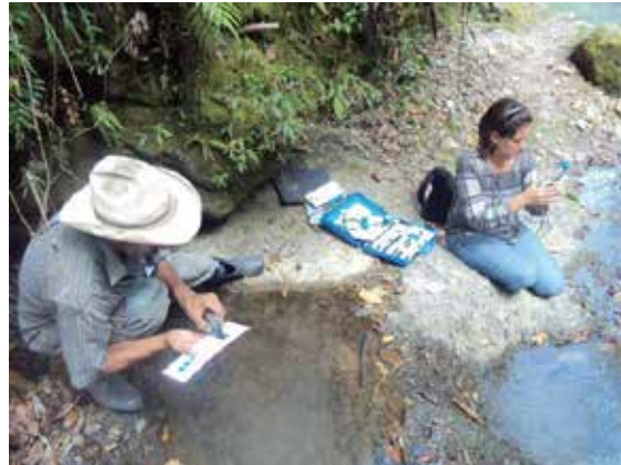
Figura 19. Medición de parámetros físico-químicos por método colorimétrico con uso del kit visocolor, en la quebrada Marroquín.
