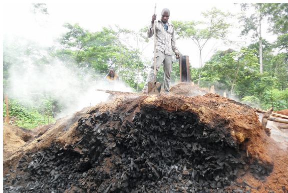
Extraction du charbon de rebuts de scierie
