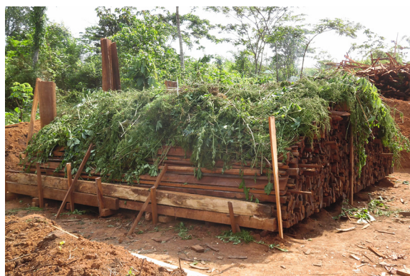
Couverture de la charge triple couche : feuillage, sciure et terre
